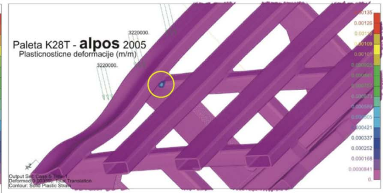
Slika 2.8 Plasticne deformacije palete K28T ( \text{m/m} )
